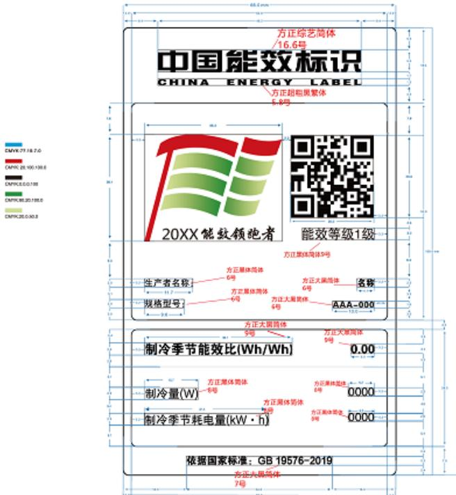
示例 1 风冷式单元式空气调节机 (单冷)
